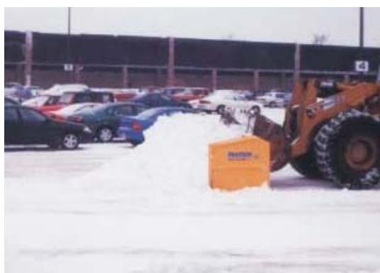
شکل ۶-۲۱: نحوه عملکرد برف‌روب جعبه‌ای.
