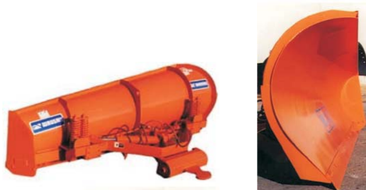
شکل ۶-۶: تیغه یکطرفه در حالت‌های مختلف.
