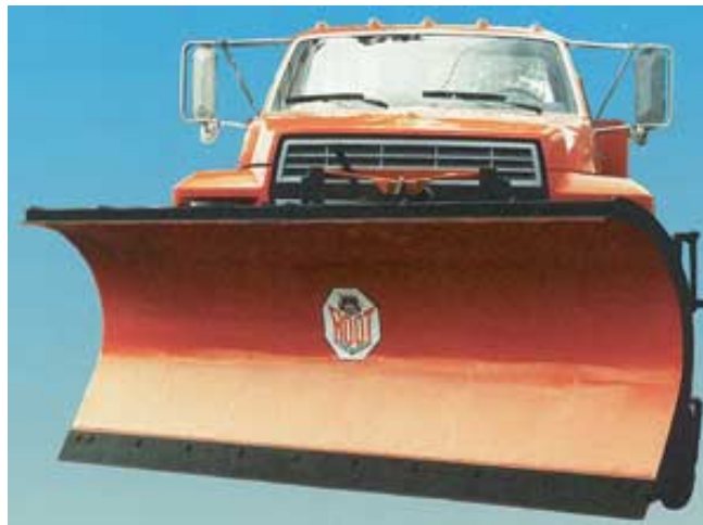
شکل ۶-۷: تیغه دو طرفه متصل به کامیون.
