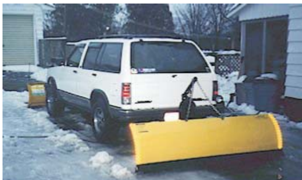
شکل ۶-۲۲: تیغه نصب‌شده در پشت استیشن.
