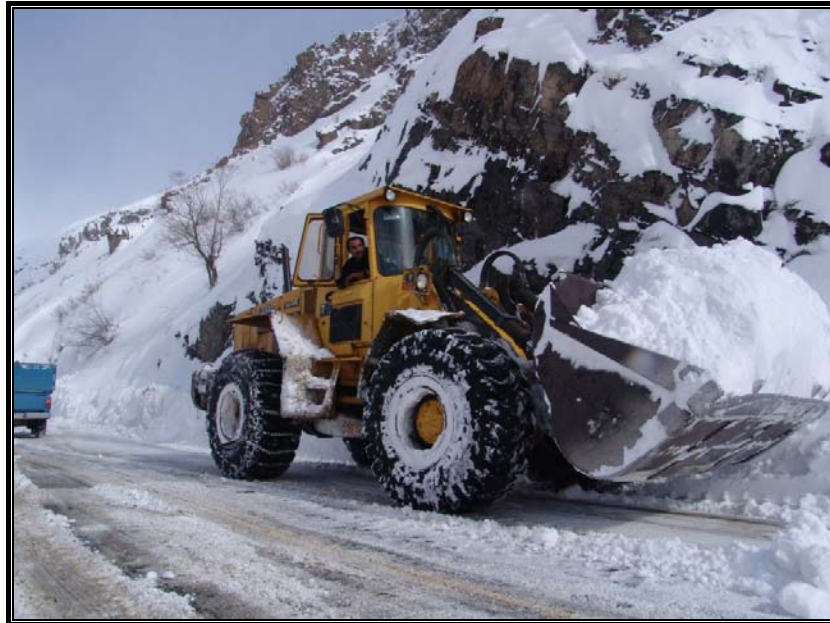
شکل ۳-۶: لودرهای پاکسازی جاده‌ها.
