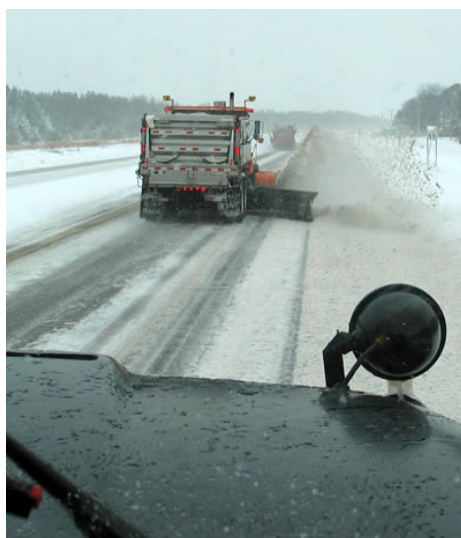
شکل ۶-۱۶: عملکرد تیغه بالای شکل و ایجاد ابر برفی.
