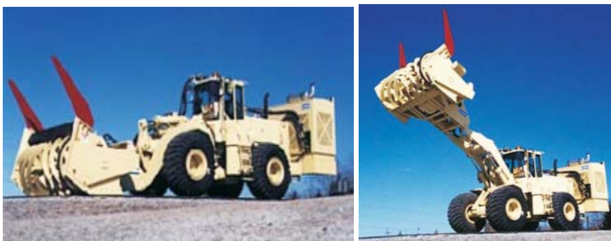
شکل ۶-۴۳: برف‌خور مجهز به پره‌های هیدرولیکی.
