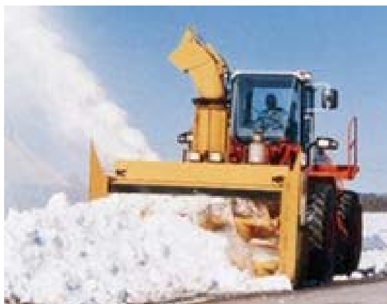
شکل ۶-۴۰: برف‌خور در حین انجام عملیات.
