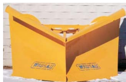
شکل ۶-۱۳: حالت‌های مختلف تیغه دو طرفه.
