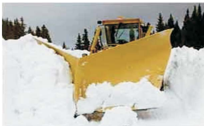
شکل ۶-۱۲: نحوه عملکرد تیغه V شکل.
