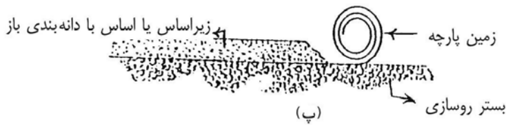
شکل ۱۱-۴ کاربرد زمین پارچه برای زهکشی زیرزمینی لایه های روسازی
