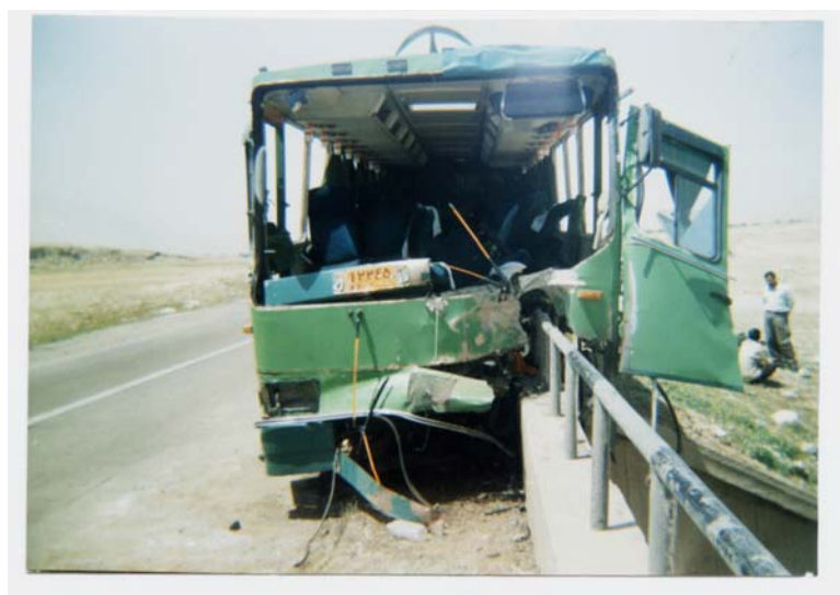
شکل ۲-۱۹: برخورد یک دستگاه اتوبوس با نرده پل به دلیل عدم ایمن‌سازی انتهای آن بازرسی ایمنی = پیشگیری از وقوع تصادف
