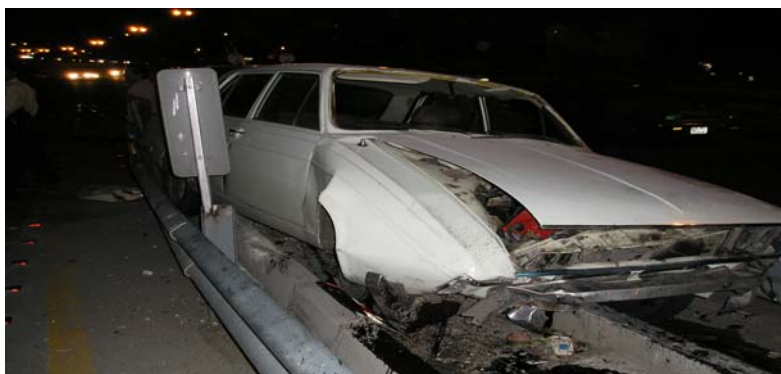
شکل ۱-۲: نصب اشتباه گاردریل در پشت جدول و عدم ایمن‌سازی انتهای جدول باعث به وجود آمدن این تصادف شده است. بازرسی ایمنی قبل از وقوع چنین تصادفی مشکل را شناسایی می‌کند.
