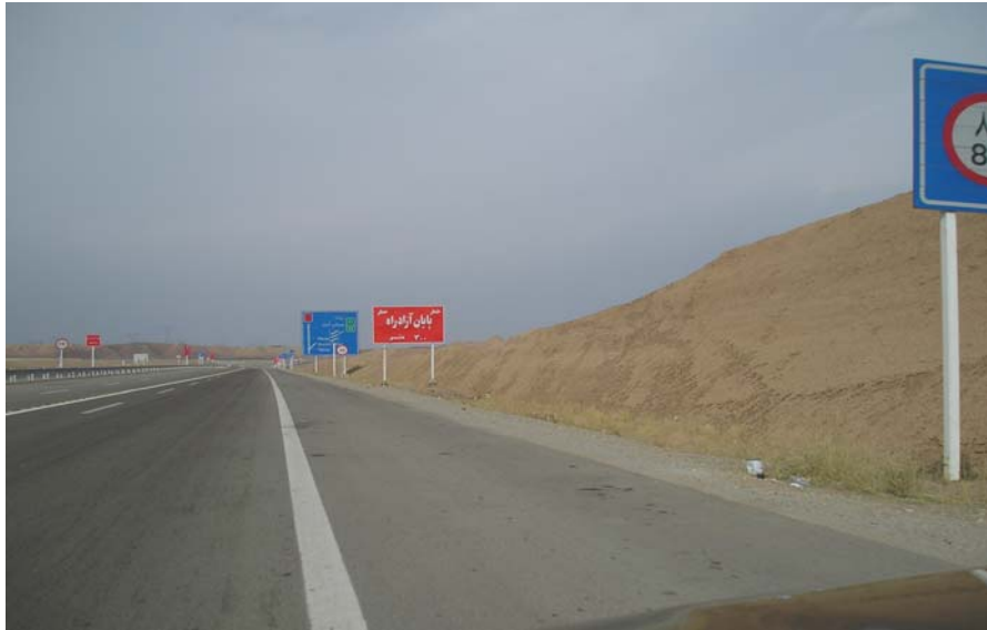
شکل ۷-۵۷: تابلوهای انتظامی و اطلاعاتی بی‌شمار نصب شده در محل خروجی که علاوه بر اینکه امکان درک آن توسط راننده وجود ندارد به راننده هیچ نوع راهنمایی در رابطه با اقدامی که باید انجام دهد ارایه نمی‌دهند.
