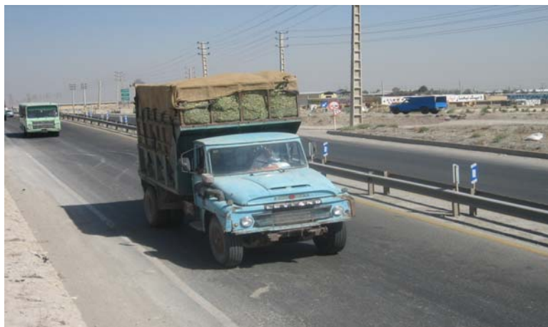
شکل ۷-۱۱۶: تردد وسایل نقلیه با ارتفاع بار زیاد و عدم نصب تابلوی محدودیت ارتفاع قبل از زیرگذر که احتمال گیرکردن این وسایل در زیر پل وجود دارد.
