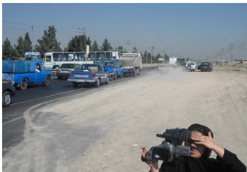
شکل ۷-۱۱۲: ایجاد صف وسایل نقلیه در محل دوربرگردان شرقی به علت تداخل حرکتی و توقف در خط سرعت به منظور گردش
