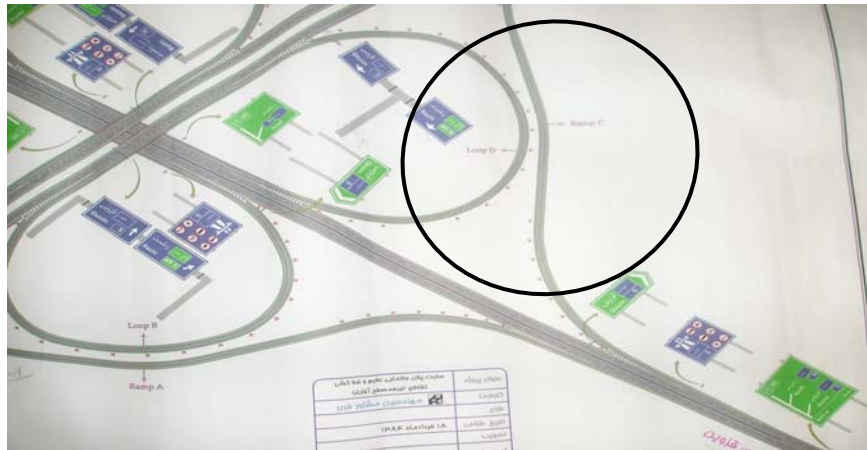
شکل ۷-۴۱: عدم وجود تابلوهای محدودیت سرعت در رمپها و لوپها، که خطر خروج وسیله نقلیه از راه را در برخواهد داشت.
