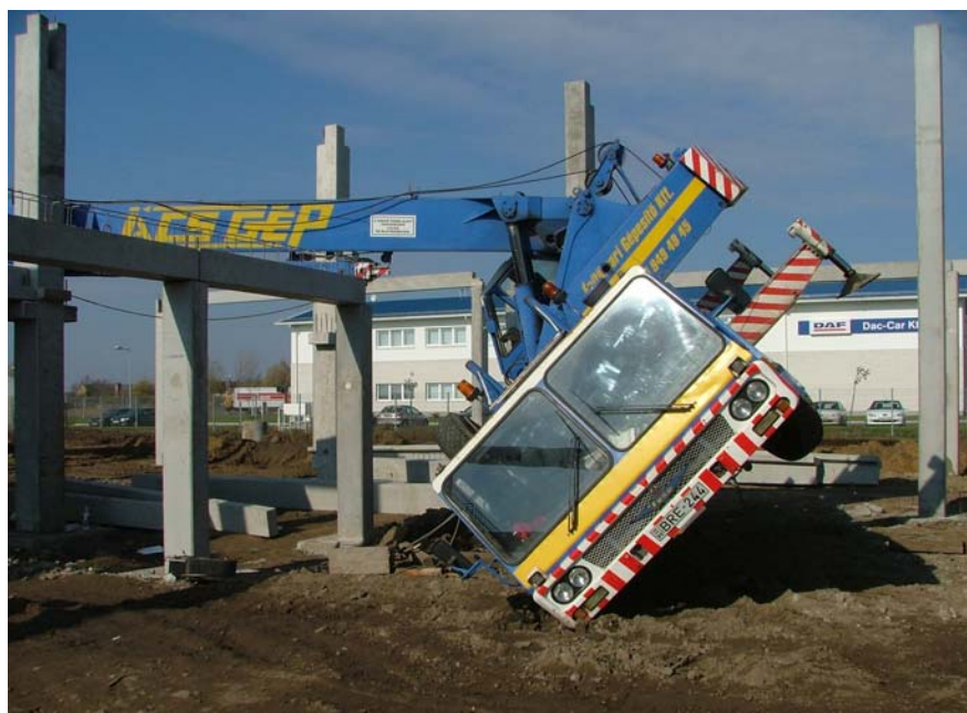
شکل ۳-۵- نمونه‌ای از سقوط یک جرثقیل متحرک
