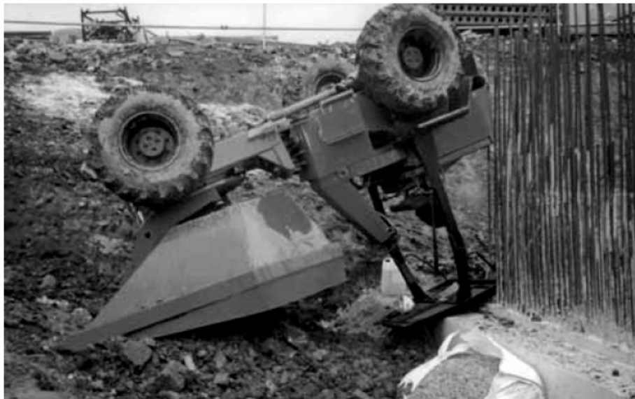
شکل ۱-۱- واژگونی دامپر در اثر عدم رعایت ایمنی
