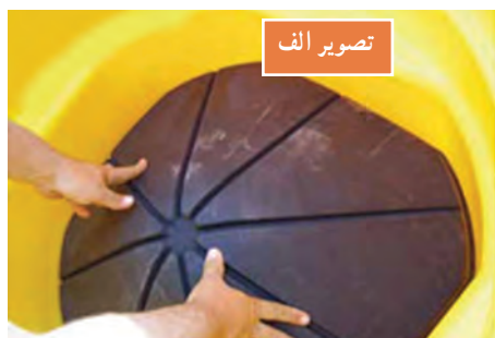
شکل ۲۲- چیدمان بشکه‌ها و قرار دهی مخروط درونی
