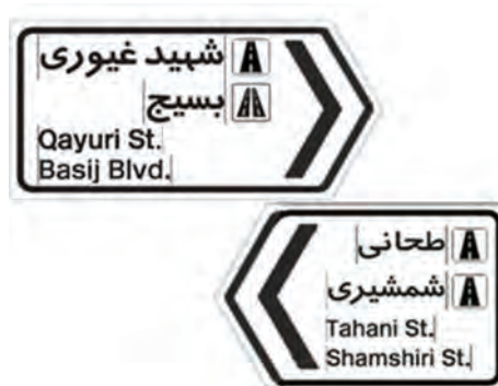
شکل ۲۵ - نمونه‌هایی از تابلوهای هدایت مسیر / خروجی (پرچی)
