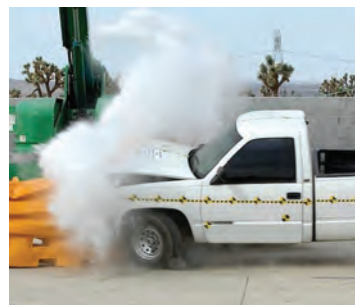
شکل ۱۲- تخریب ضربه گیرهای وزنی بشکه ای بعد از برخورد
