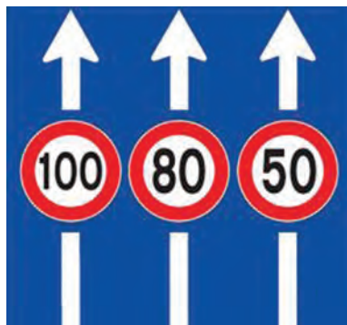
شکل ۳۴- تابلوی حداکثر سرعت در آزاد راه
