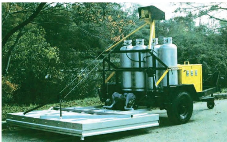
شکل ۴۷ - تجهیزات صفحه گرمکن
