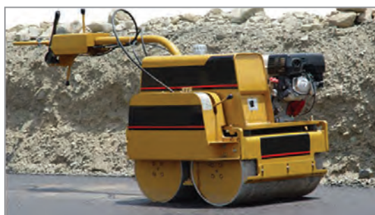
شکل ۴۱- غلتک دستی برای تراکم آسفالت
